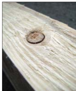
Рис. 5. Сучки снижают визуальное качество и прочность лесоматериала
