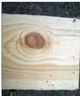
Рис. 5. Сучки снижают визуальное качество и прочность лесоматериала
