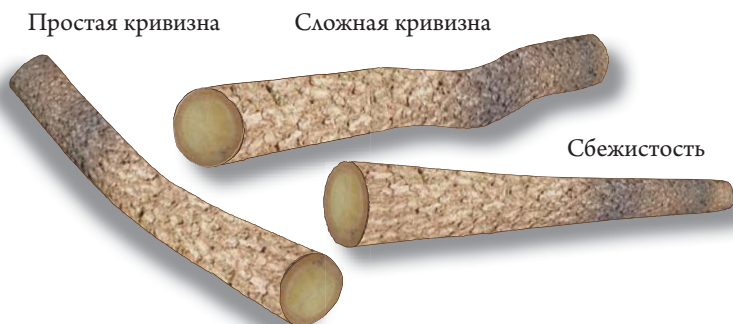
Рис. 7. Кривизна и сбежистость снижают выход пиловочника и баланса. Они также могут влиять на внешний вид и прочность лесоматериала
