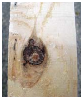
Рис. 5. Сучки снижают визуальное качество и прочность лесоматериала
